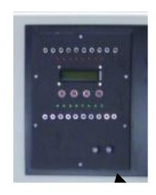
El dispositivo está conectado directamente a los módulos de entradas y salidas del robot. La interfaz envía señales a los módulos y el robot ejecute las tareas indicadas de acuerdo con el algoritmo del proceso de manufactura.
